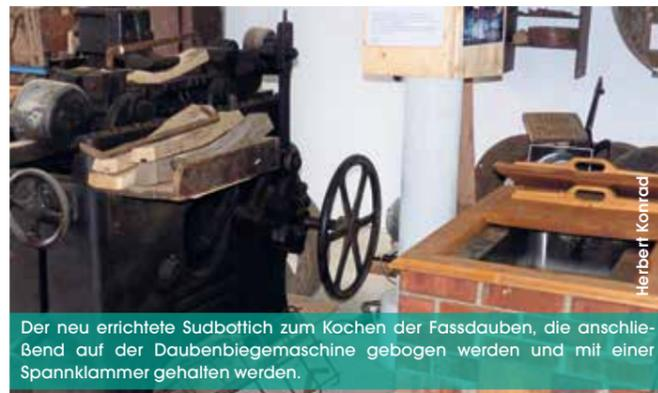
Der neu errichtete Sudbottich zum Kochen der Fassdauben, die anschließend auf der Daubenbiegemaschine gebogen werden und mit einer Spannklammer gehalten werden.
